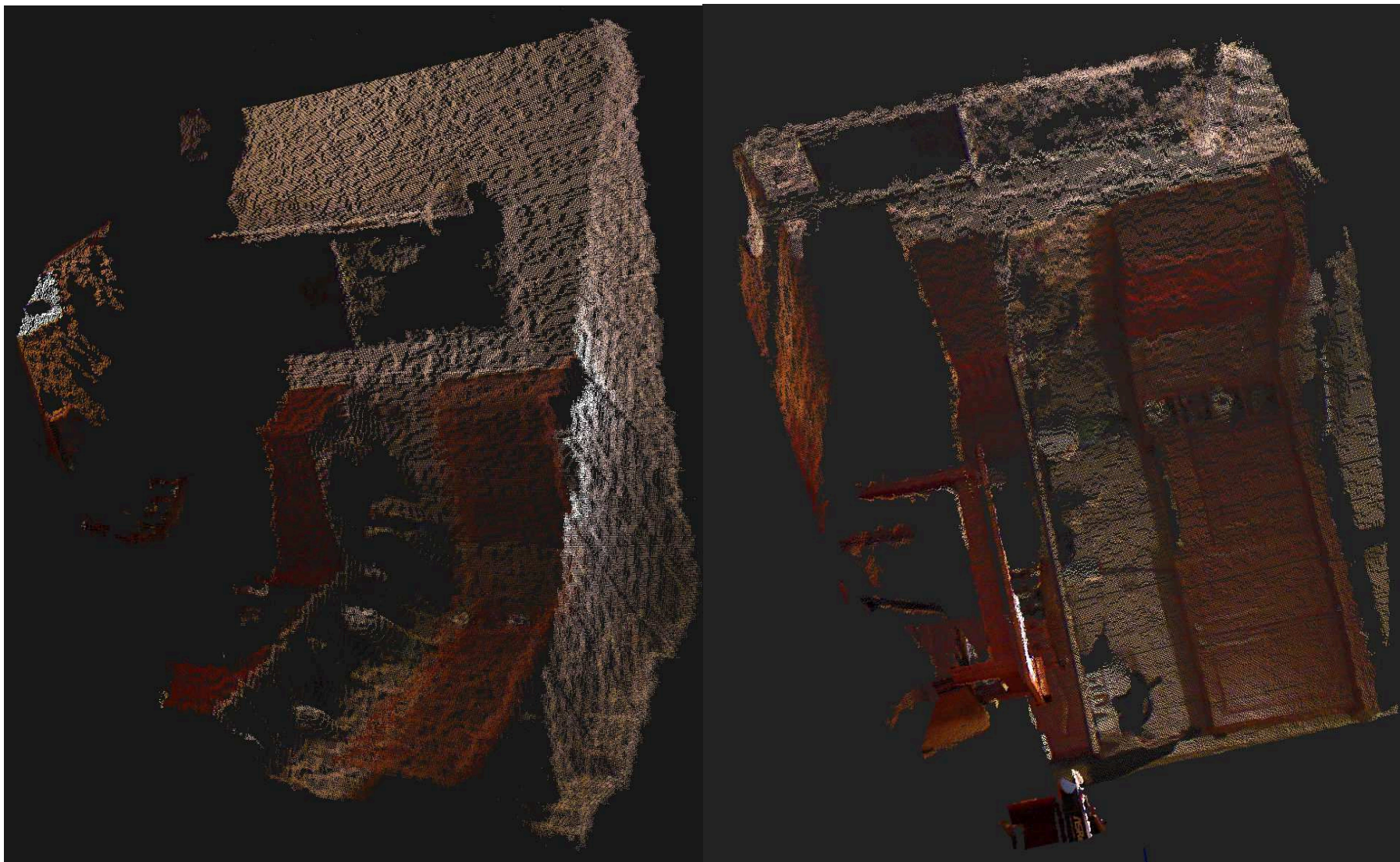
5.2. A fenti képeken láthatóak a műszer infravörös szenzorának kimeneti adatfolyamából a szofver által generált és megjelenített pointcloud modell, és a modell pontjaihoz hozzárendelt színek, melyek a műszer RGB kamerájának adatfolyamából származnak.
