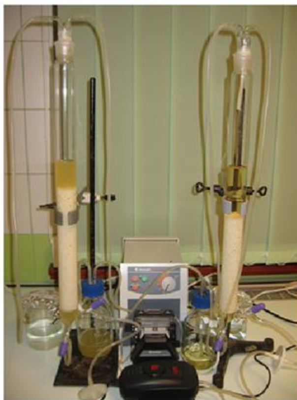
13. ábra - Az oszloptöltet sematikus rajza, valamint az üzemben lévő oszloptöltetről készült felvétel
