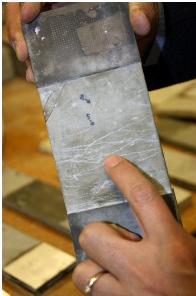
16.sz. kép Az öngyógyító beton kísérlet utáni állapota
