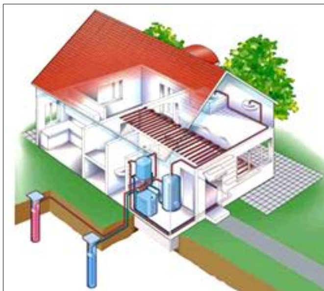
17. ábra Hőforrásoldal kialakítása (víz-víz hőszivattyú) (forrás: http://www.solartrade.hu/hoszivattyu/geotermikus-hoszivattyu/ )
