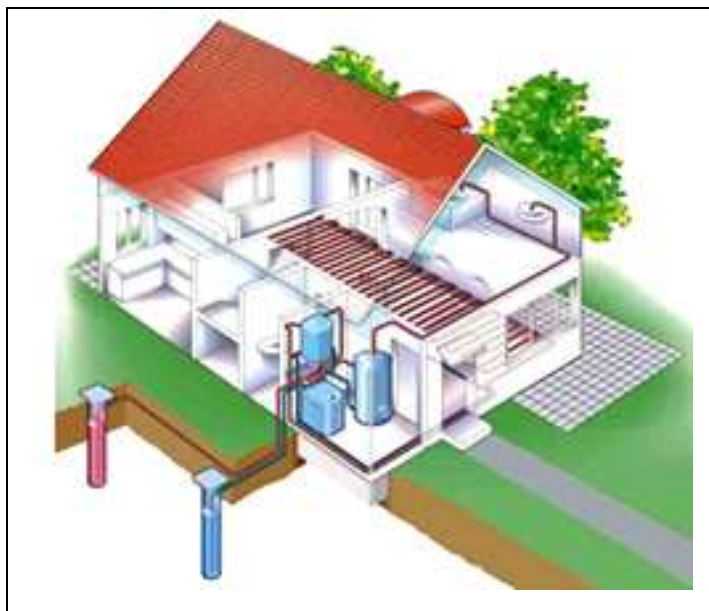
17. ábra Hőforrásoldal kialakítása (víz-víz hőszivattyú) (forrás: http://www.solartrade.hu/hoszivattyu/geotermikus-hoszivattyu/ )
