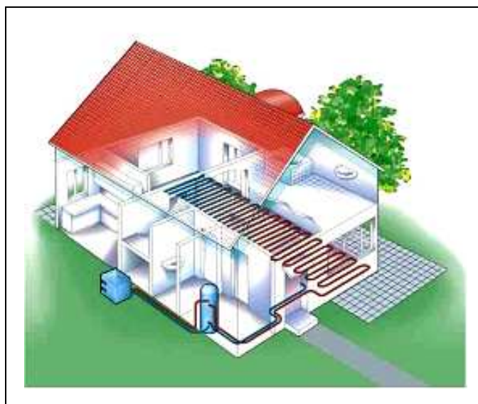
21. ábra Levegő-víz hőszivattyú kültéri elhelyezése
