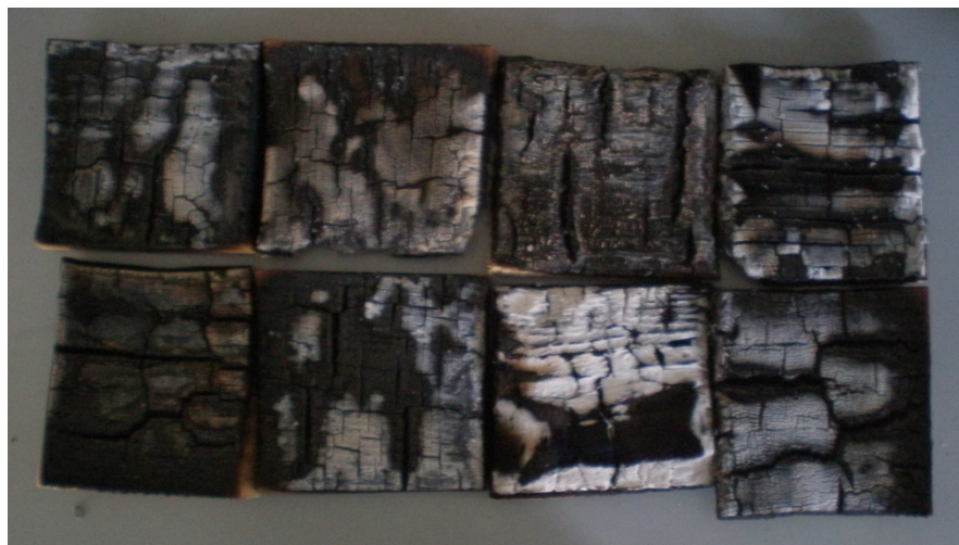
Az első kalibrálásnál használt mintadarabok összessége az égetést követően
