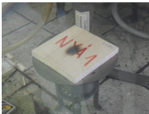
A nyárfa átégése a vizsgálat alatt
