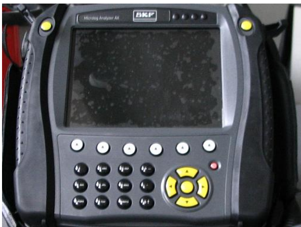
4.23. ábra: SKF Microlog AX rezgésdiagnosztikai rendszer és gyorsulásérzékelője
