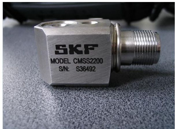
4.23. ábra: SKF Microlog AX rezgésdiagnosztikai rendszer és gyorsulásérzékelője
