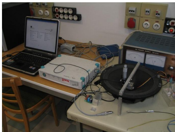
4.19. ábra: Mérési összeállítás a frekvenciafüggés meghatározásához
