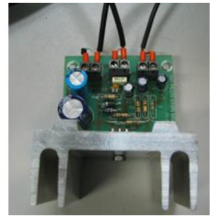
4.9. ábra: Erősítő kit csomagolása és összeszerelve hűtőbordával
