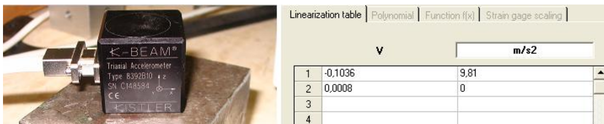
3.11. ábra: Kistler K-Beam kalibrálása
