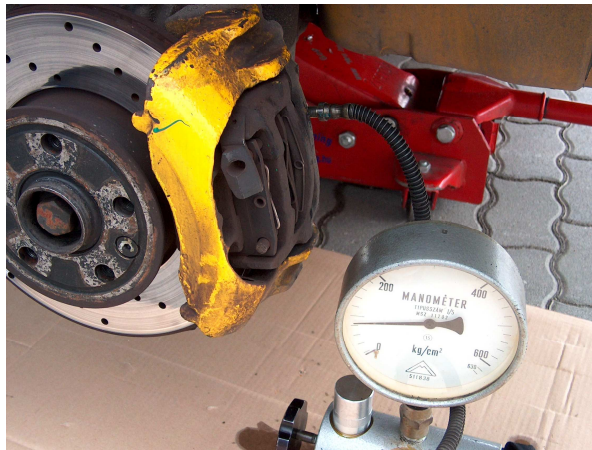
28. ábra: Kisteherautó féknyomásának mérése
