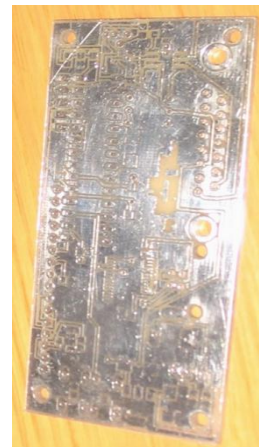
5.5. ábra A NYÁK-terv két oldala és az elkészült áramkör
