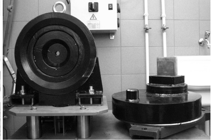
5. kép: M30 kompressziós tekercs illeszkedő térformálóval (balra), síktekercs (jobbra; a kísérlet során nem használtuk)
