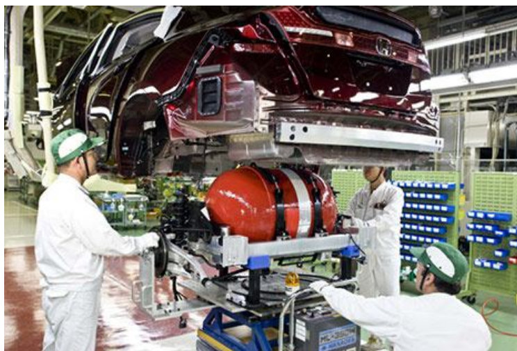
35. kép Honda FCX Clarity hidrogén tartálya
