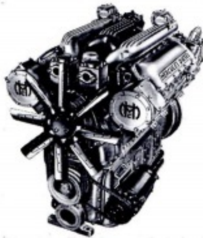
22. kép A Talgo vonat V8-as motorblokkja
