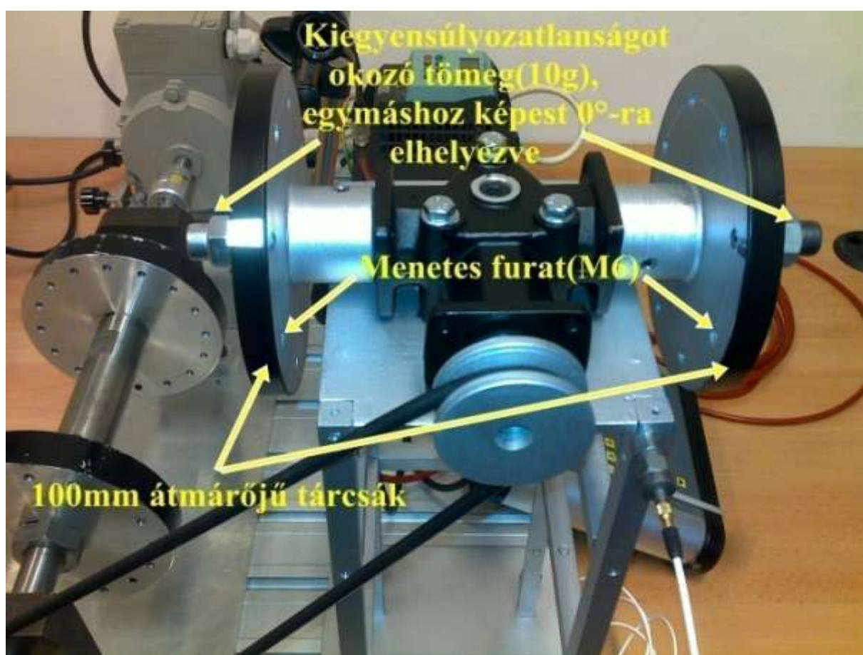
4.4.ábra Próbátömegek elhelyezése a tárcsán[saját szerkesztésű kép]
