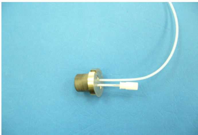
3.6. ábra. Az előzőtesen kifejlesztett szeptumos injektor rendszer
