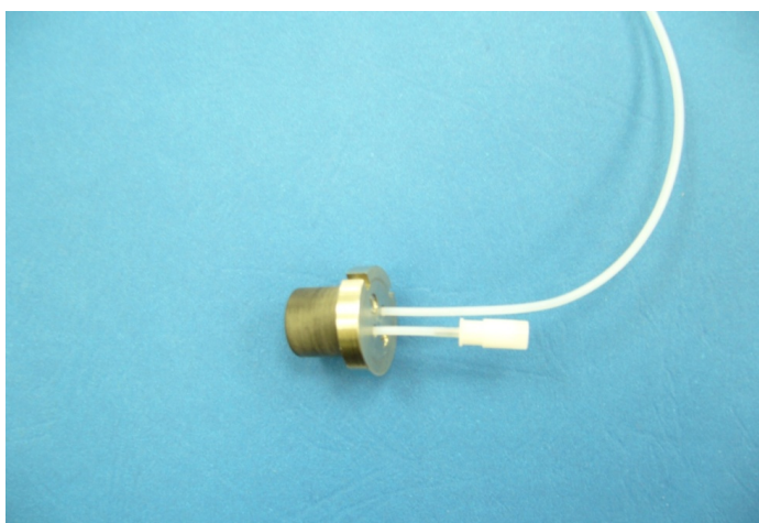
3.6. ábra. Az előzőtesen kifejlesztett szeptumos injektor rendszer
