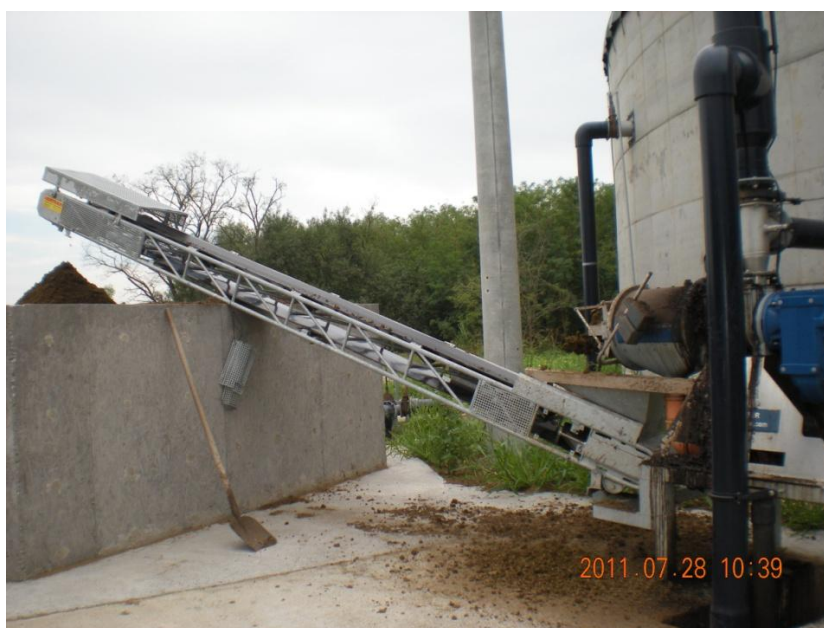
2.kép: A szilárd- és a híg rész elválasztása a szeparáló állomáson (Fotó: Hankovszky G., 2011)
