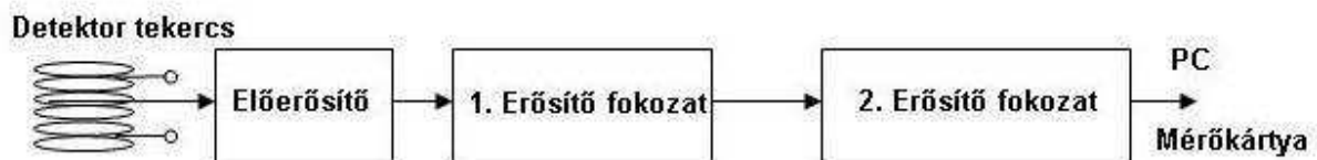
7.b ábra: Erősítő és jelkondicionáló egység blokkvázlata
