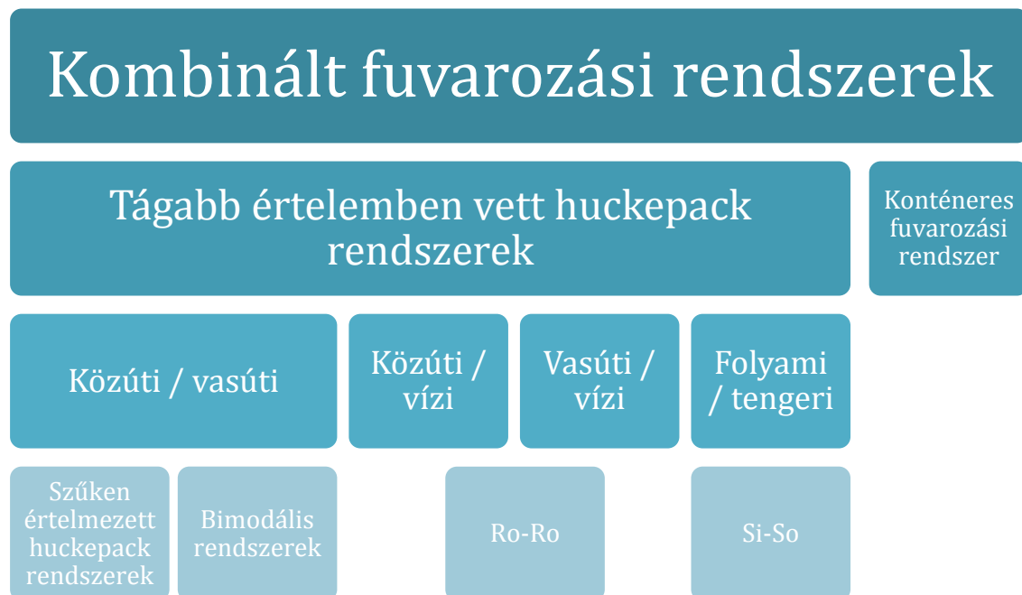
1. ábra A kombinált továbbítási rendszerek összefoglaló ábrája (Forrás: saját szerk. Nyakasné, 2002, p.8. alapján)
