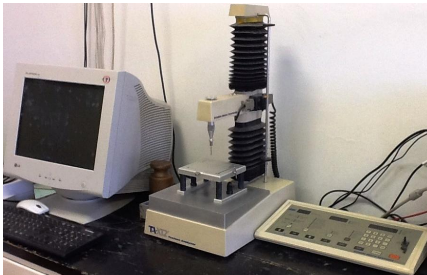
13.ábra Stable Micro System Texture Analyser (balról jobbra számítógép a program futtatásához, SMS mérőkészülék és az irányítópultja)
