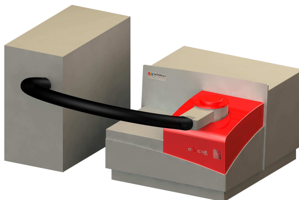
12. ábra: Setaram DSC evo 131 típusú kaloriméter ( www.setaram.com )
