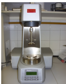
14. ábra: Physica MCR51 típusú viszkoziméter
