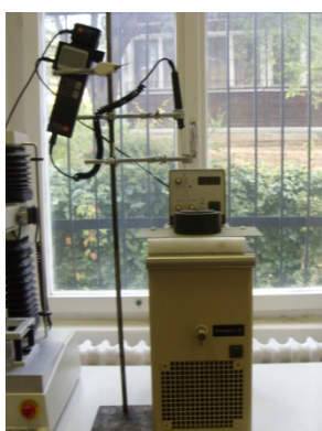
10. ábra: Kriosztát és a Testo 452 mérőkör (forrás: saját)
