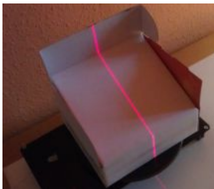
3.7 ábra. Kartonlappból készült kalibrációs segédeszköz
