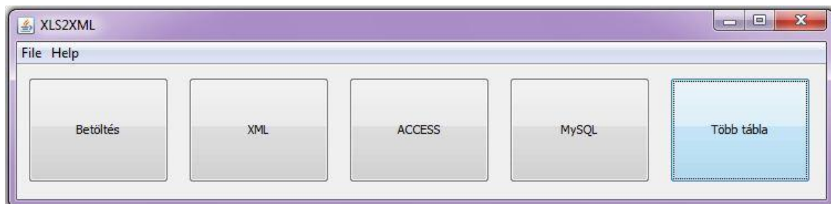
10. ábra: Több XML fájl előállításához a Több tábla gombot kell alkalmazni
