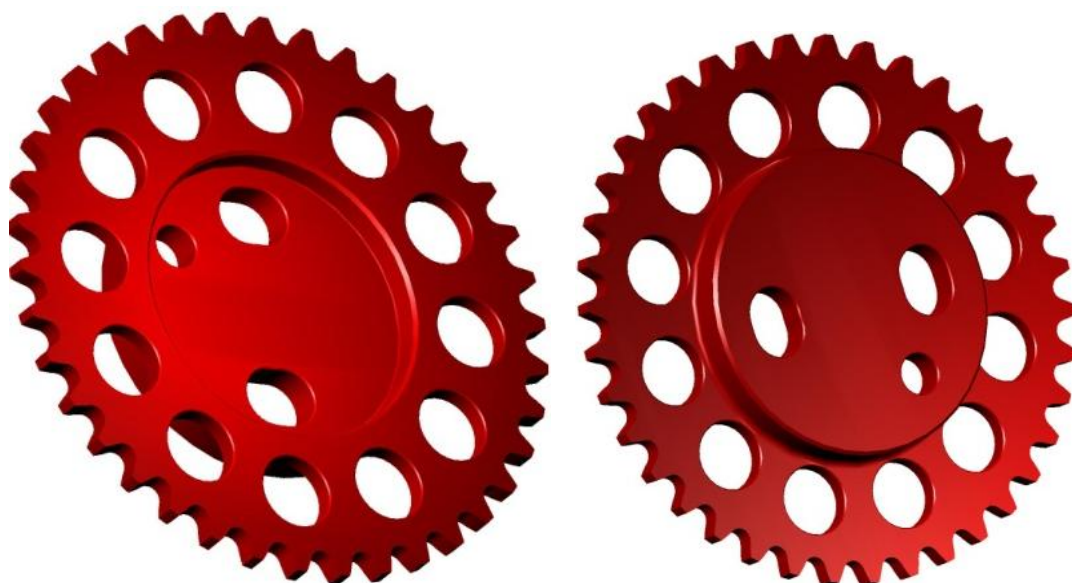
8.4.9. ábra: A kipufogó oldali vezérműtengely lánckerekének a harmadik modellje
