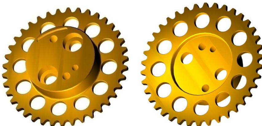
8.3.8. ábra: Kipufogó oldali vezérműtengely lánckerekének második modellje
