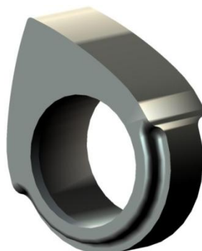
8.3.5. ábra: Vezérműtengely bütyök profilja
