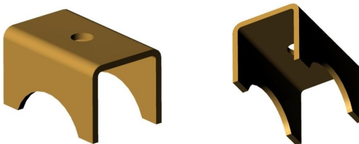
8.6.16. ábra: A szívó oldali vezérműtengely egyik csapágyának a támasztó lemeze
