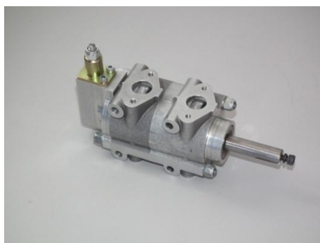
11. ábra COMP C7 olajszivattyú
