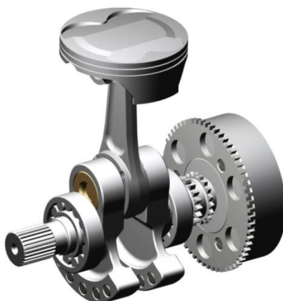
7. ábra A forgattyús mechanizmus a golyóscsapágyakkal
