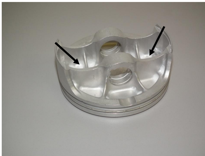
6. ábra A fúvókákkal megcélzott területek a dugattyún
