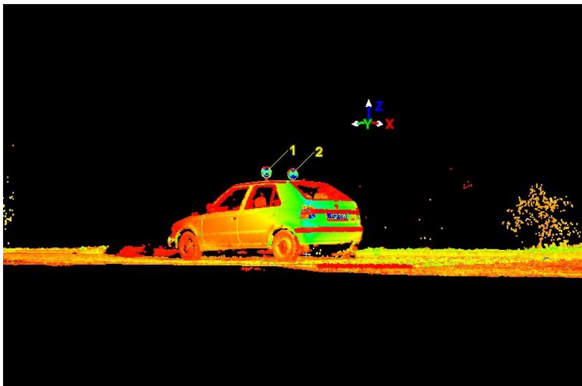
1. ábra Autó nyers pontfelhője illesztőpontokkal
