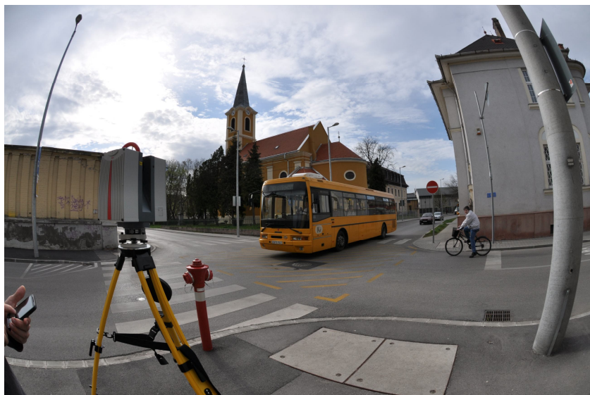
7. ábra Csomópont szkennelése, a digitális fényképezőgép halszem objektívjével készült képen
