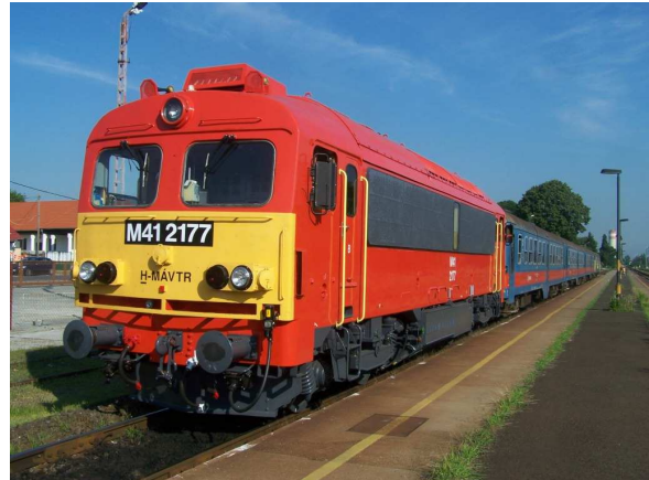
2. ábra M41 sorozatú univerzális dízel-hidraulikus mozdony, Fotó: Urbán István
