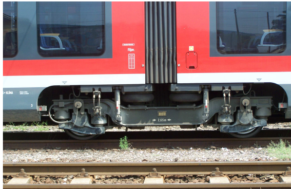
12. ábra Jacobs forgóváz Desiro motorvonat alatt, Fotó: Urbán István
