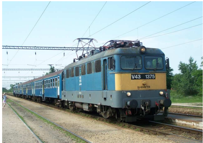
5. ábra V43 sorozatú szilícium egyenirányítós univerzális villamos mozdony, Fotó: Urbán István
