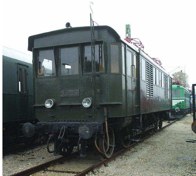
4. ábra V40 sorozatú Kandó-rendszerű villamos mozdony, Fotó: Urbán István
