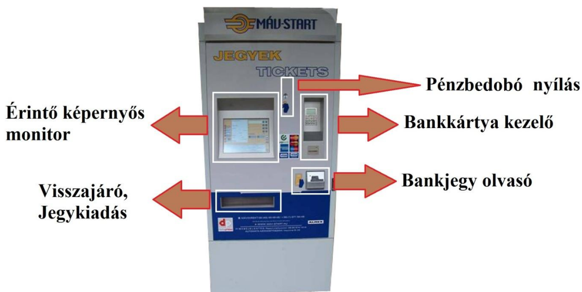
5. ábra. Állomási jegyértékesítő automata részei
