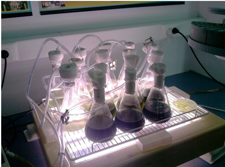
3.2. ábra. A fotobioreaktorra helyezett algatenyészet
