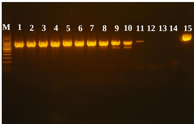
3. ábra A BojA/858left hőmérséklet grádiens PCR eredménye az EKF55 Lb. gasseri törzs DNS-ével, az E8F/E1115R ellenőrző PCR-rel kiegészítve. M: 100 bp Benchtop Ladder. Az annealing hőmérsékletek: 1: 50 °C, 2: 51,9 °C, 3: 53,8 °C, 4: 55,7 °C, 5: 57,5 °C, 6: 59,2 °C, 7: 60,8 °C, 8: 62,5 °C, 9: 64,3 °C, 10: 66,2 °C, 11: 68,1 °C, 12: 70,0 °C. 13: BojA/858left NTC 50 °C-on. 14: E8F/E1115R NTC 50 °C-on. 15: E8F/E1115R termék 64,3 °C-on. A gélelektroforézist 1%-os agaróz gélen végeztük, 120V feszültségen 30 percig. A géltre 5 µl mintát vittünk fel.
