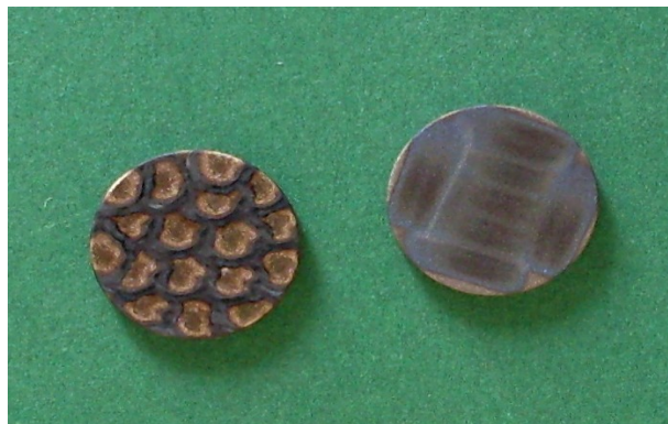
5. ábra: A Nd:YAG lézerrel (balra) és a KrF excimer lézerre (jobbra) kezelt minták
