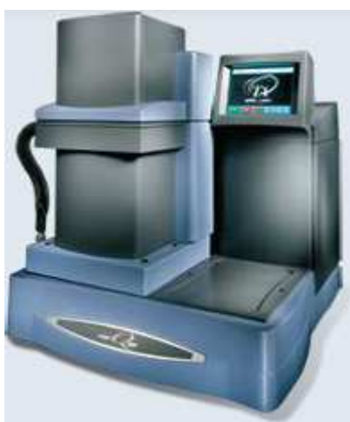
14. ábra: Q800 típusú DMA műszer és a mérésekhez használt Tension:Film típusú mérőfej
