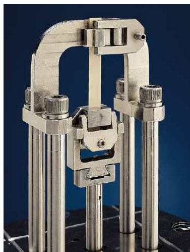
14. ábra: Q800 típusú DMA műszer és a mérésekhez használt Tension:Film típusú mérőfej
