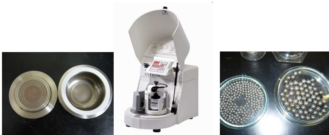
10. ábra: Fritsch P6 típusú bolygó golyós malom, rozsdamentes acél őrlőedény és rozsdamentes acél őrlőgolyók
