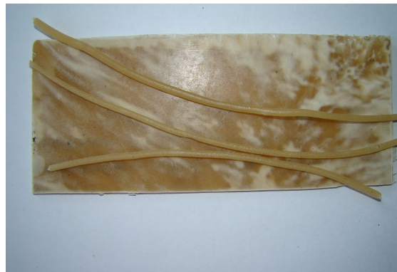
17. ábra BIO-1 jelű kompozitról készített fénykép (0/50% faliszt/keményítőtartalmú töltőanyag arány)
