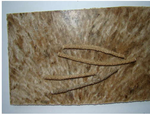
21. ábra BIO-4 jelű kompozitról készített fénykép (35/15% faliszt/keményítőtartalmú töltőanyag arány)
