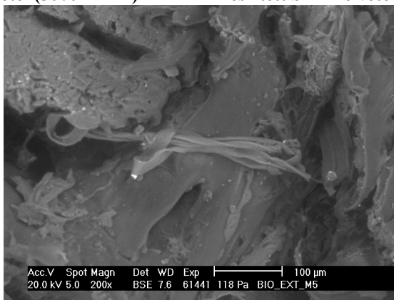
26. ábra BIO-4 jelű minta szakítási felületéről készített SEM felvétel (15% KM-1/35% faliszt)
