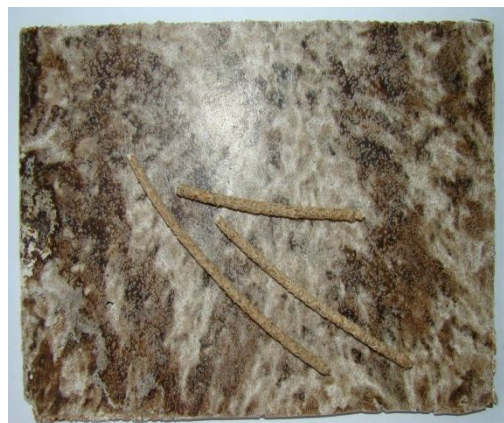
19. ábra BIO-3 jelű kompozitról készített fénykép (25/25% faliszt/keményítőtartalmú töltőanyag arány)
