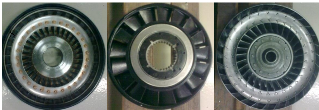
8. ábra Nyomatékvtó részei: Szivattyúkerék, Átvezető kerék, Turbinakerék - Forrás: [5]
