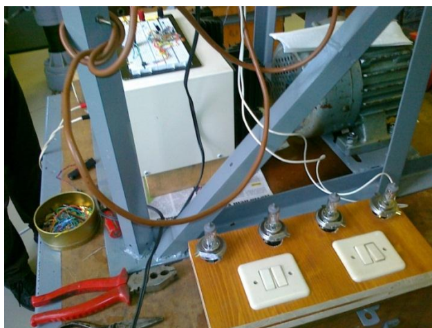
30. ábra Forrás: 4x55W-os izzóellenállás
