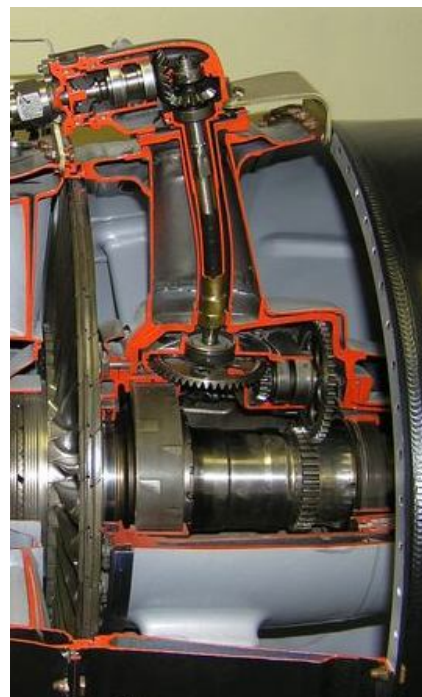
213. ábra: A negyedik és ötödik támasz, valamint a szabadturbina fordulatszám adója (hajtómű metszet)
