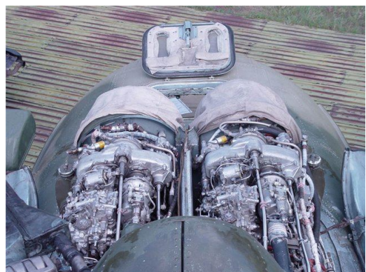
3. ábra: A TV3-117 hajtómű a helikopterbe beszerelt állapotban
