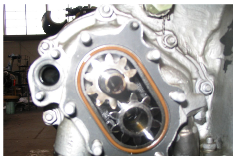
16. ábra: A segédberendezés házból az olajat visszashállító szivattyú (szétszerelt állapotban)
