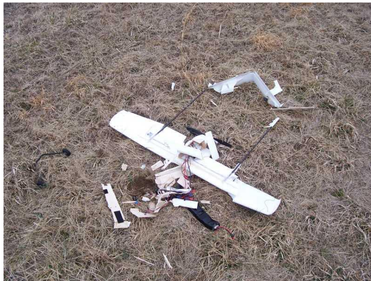
8. kép: Földnek ütközött UAV
