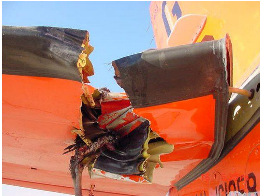
7. kép: Madárral való ütközés okozta károsodás a szárnyon
