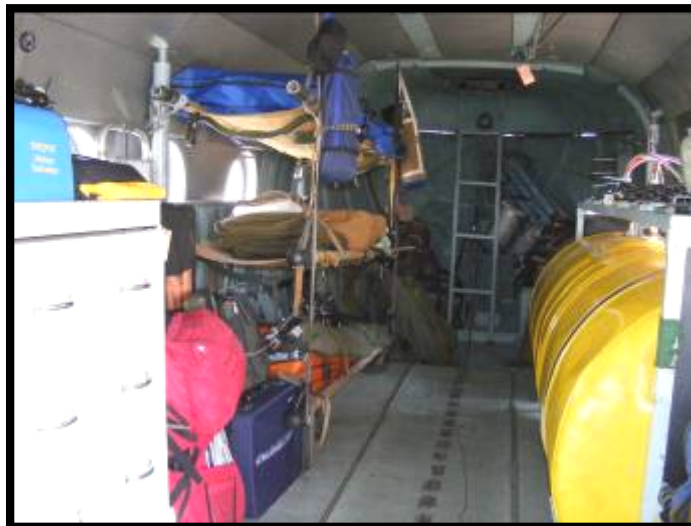
10. számú fotó: Kutató-mentő helikopter berendezve 3 fő fekvő és 3 fő ülő sérült szállítására
