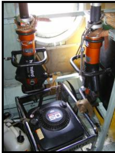
8. számú fotó: A kutató-mentő gép hidraulikus műszaki mentő felszerelése Készítette: Kiss Béla főhadnagy, (készítés ideje: 2012. 03. 28)
