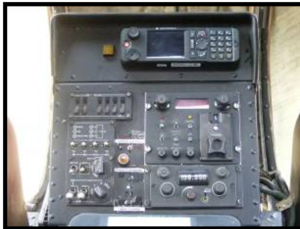
7. számú fotó: Kutató-mentő helikopter EDR rádiója
