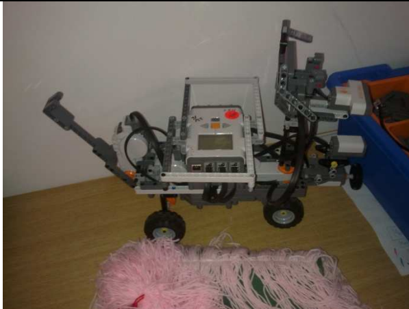
A két hajtott és két kormányzott kerekű robot
