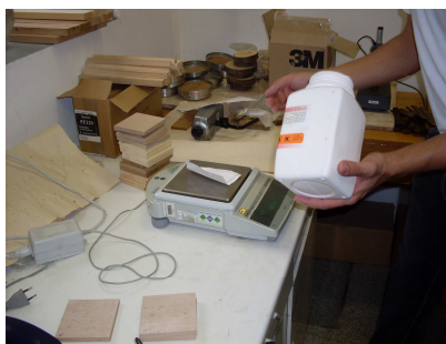
Kép: Tömegmérésre alkalmas analitikai mérleg
