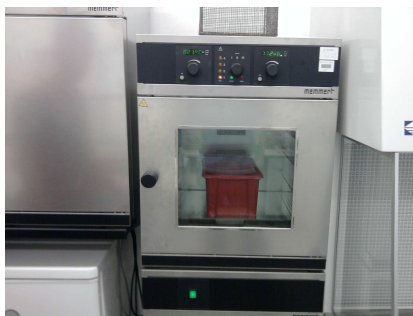
7.Kép: Telítést segítő vákumszáritó
