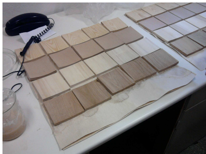
Kép: Kezelésre előkészített szabványos próbatestek
