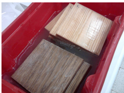
kép: A próbatestek szuszpenzióba helyezése
