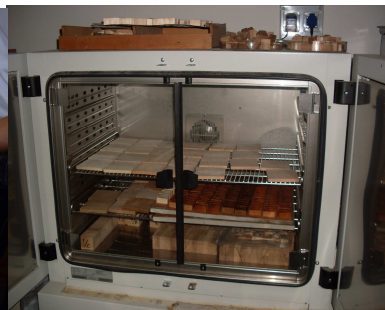
Kép: Szabványkörülmények betartását segítő klímasekrény
