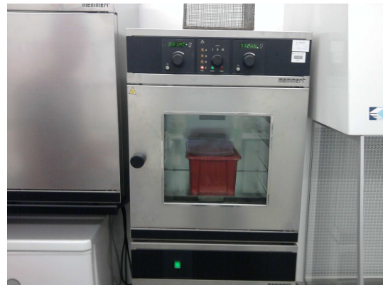
6.Kép: telítési eljárás tellítés közben (intézeti vákuumszáritó)
