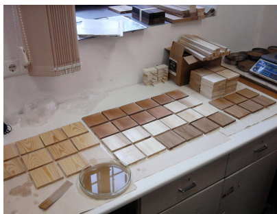
kép: Az elkészített próbatestek beáztatása
