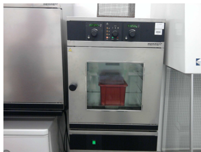
kép: Az anyagok vákuumszáritóval való bevittele
