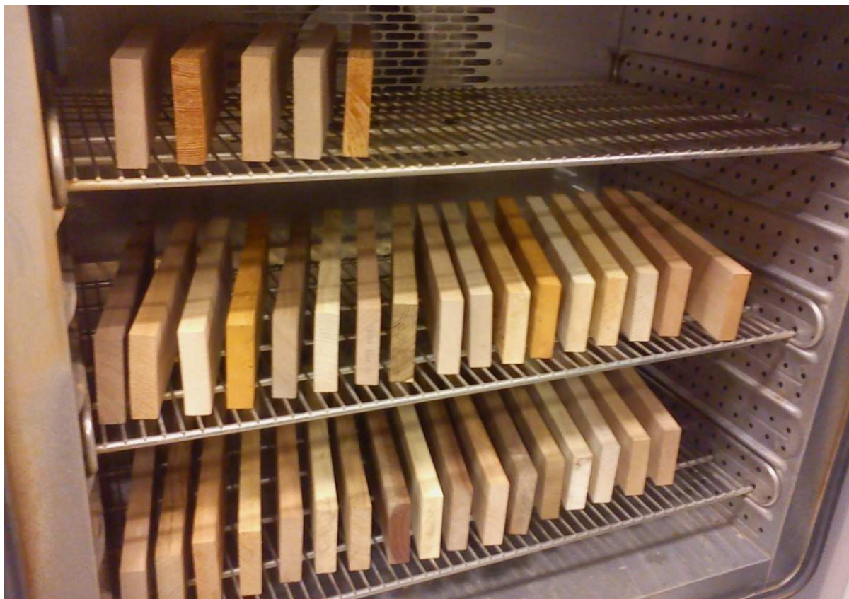
2. kép Próbatestek a klímakamrában
