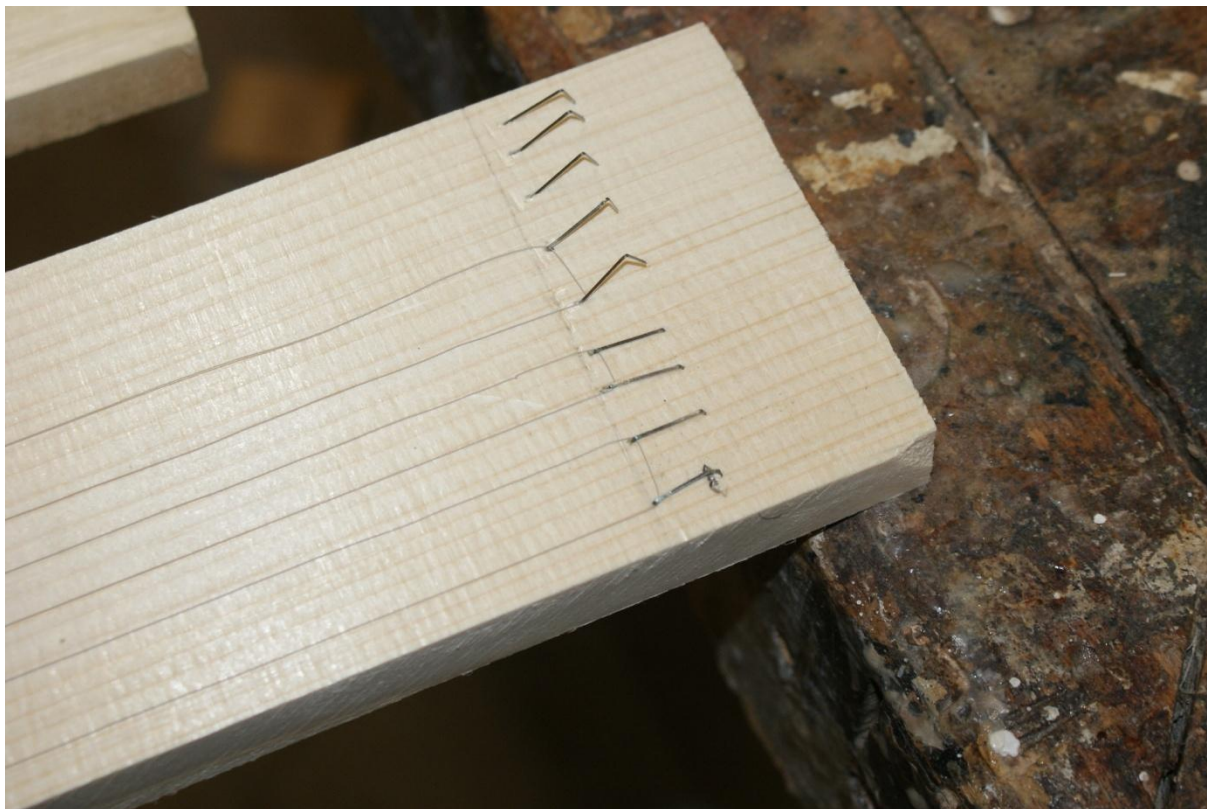
16. ábra: Az alsó lamellához 8-szoros hosszban tűzőkapcsokkal kifeszített Konstantán huzal
