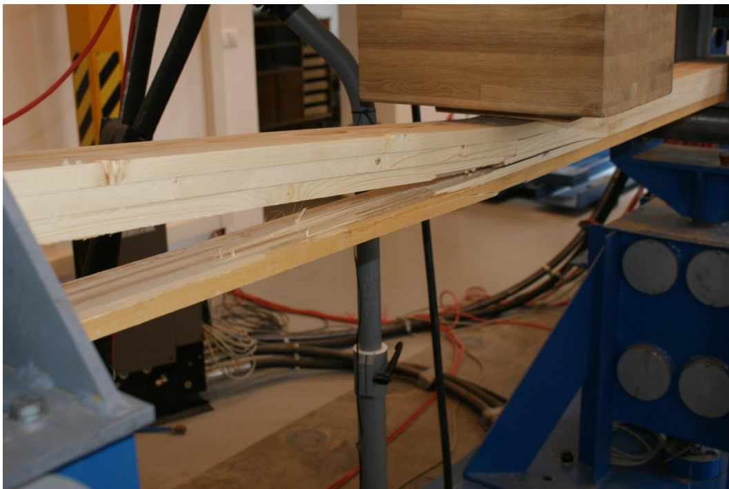
20. ábra: A 7-es számú próbatest tönkremenetele (a nyomott övben ment tönkre a lamella előbb), a beragasztott huzal elszakadásával az ellenállási érték végtelen lett
