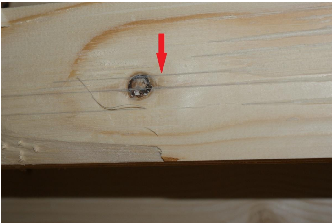
22. ábra: A 7-es számú próbatest tönkremenetelénél jól látszik, hogy a ragasztó feszesen tartja akkor is a huzalt, ha a beragasztáskor mégsem sikerül feszesre húzni
