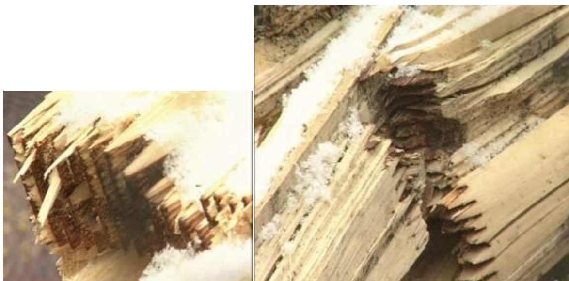
3. ábra: A közeli fényképeken jól látszik, hogy a hosszoldásoknál a ragasztóanyag teljesen funkcióját veszítette, az ékcsapos hosszoldás gyakorlatilag nem működött (Forrás: http://www.konrad-fischer-info.de/DA09.JPG ; http://www.konrad-fischer-info.de/DA13.JPG )
