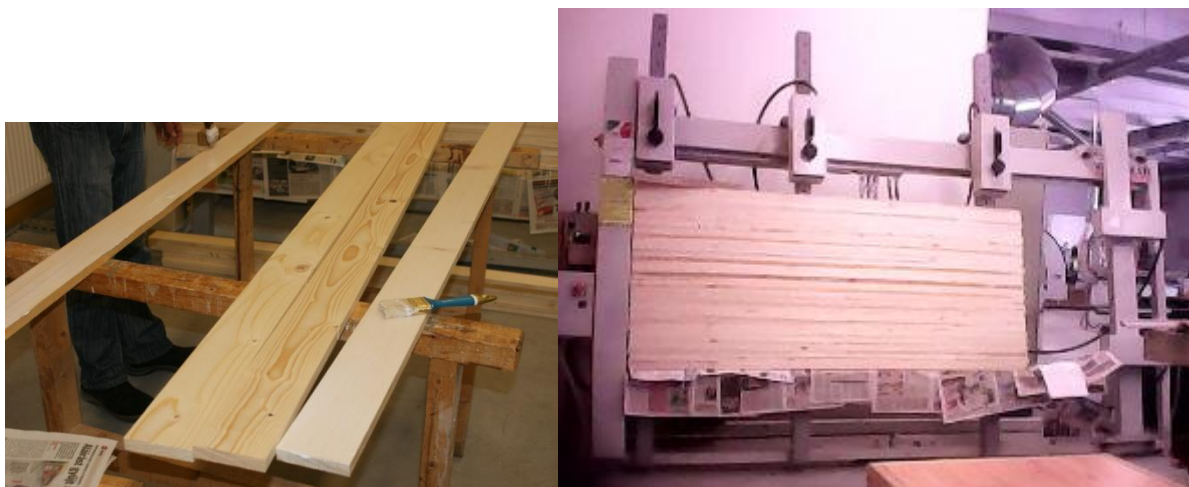
17. ábra: A ragasztási folyamat: ecsettel történő ragasztó felhordás és hidraulikus préselés
