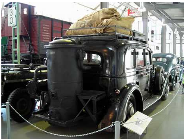
11. ábra: II: világháborúban használt fagázzal működő teherautó Forrás: Mechanical Wood Products Branch (1986) 6 ábra
