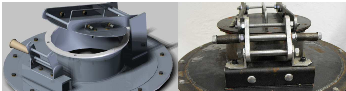
15. ábra: Az általunk elkészített robbanás biztos tető 3D-s terve és a már készítő.
