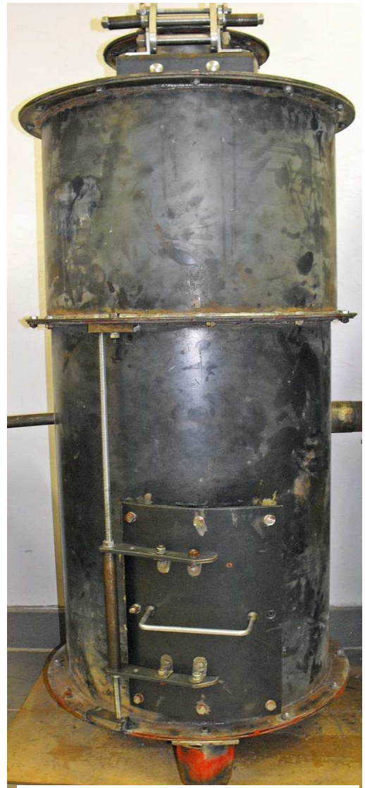
1. ábra: Az elkészült fagázgenerátor Forrás: Saját fotó
