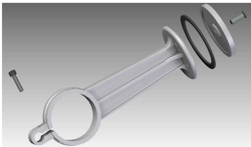
32. ábra: Az általunk tervezett, átalakított Dugattyú 3D-s terve Forrás: Saját fotó
