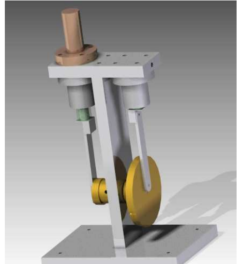
20. ábra: alfa stirling változat, általunk készített 3D-s modellje Forrás: Saját fotó
