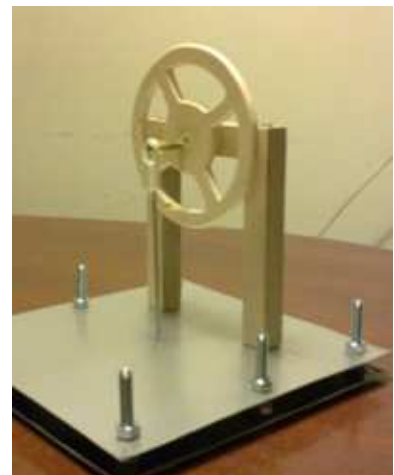
22. ábra: Az általunk készített béta típusú stirling-motor. Forrás: Saját kép
