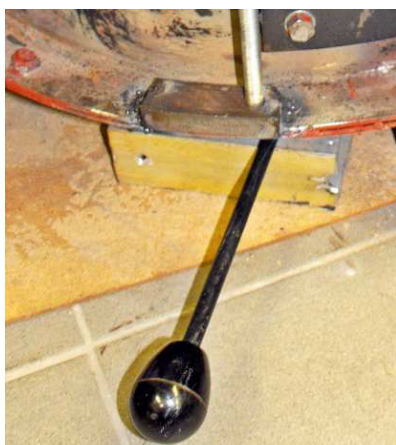
14. ábra: Az általunk elkészített Bolygató rendszer fogókarja. Forrás: Saját fotó
