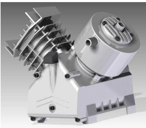
3. ábra: Az általunk tervezett Stirling-motor 3D-s modellje Forrás: Saját fotó
