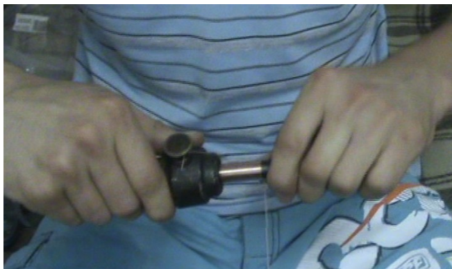
(V.2.ábra): A rugó elkészítése; feltekerés rúdra.
