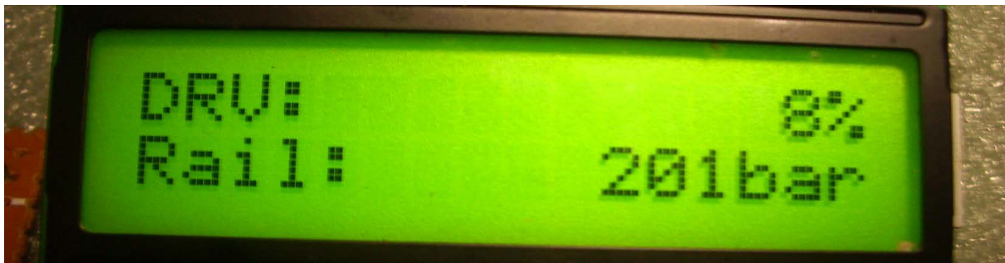
13. Ábra. A nyomás pillanatnyi értékének a kiírása LCD-re
