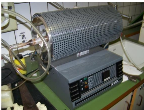
18. ábra. A hőkezelő berendezés
