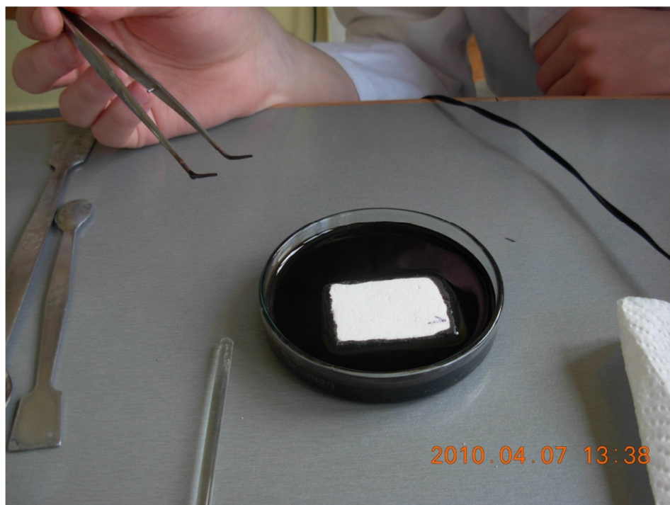
3. Kép: Karbamidgyantából készült granulátum az első kísérletben
