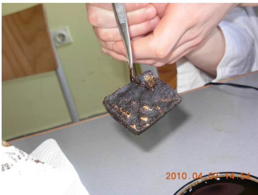
4. Kép: Karbamidgyantából készült granulátum az első kísérlet után
