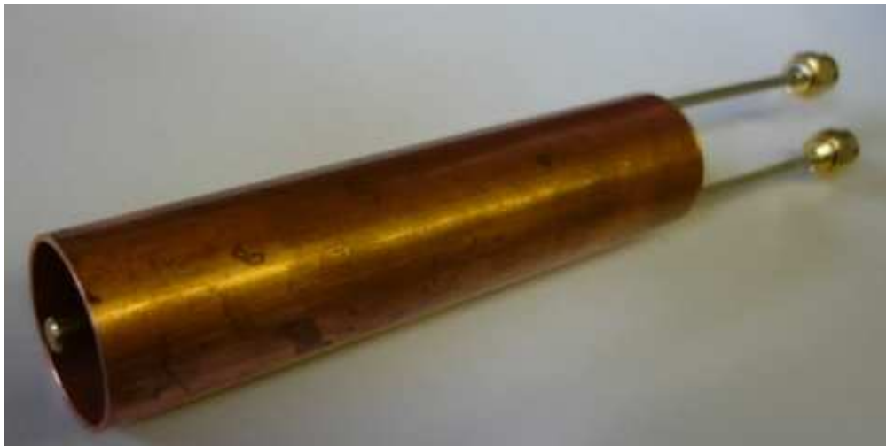
2.9. ábra: Megvalósított koaxiális rezonátor
