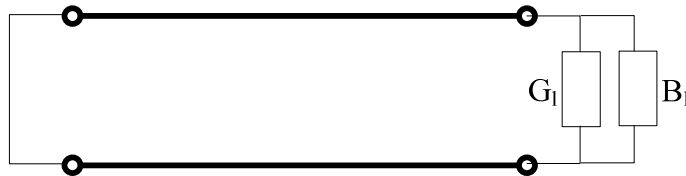
2.3. ábra: Adott komplex permittivitású mintával terhelt koaxiális rezonátor távvezeték modellje
