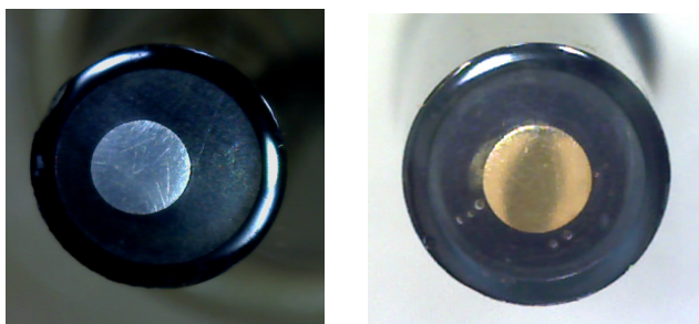
4.6.5. ábra Platinázott felületű réz elektród, és arany elektród képe
