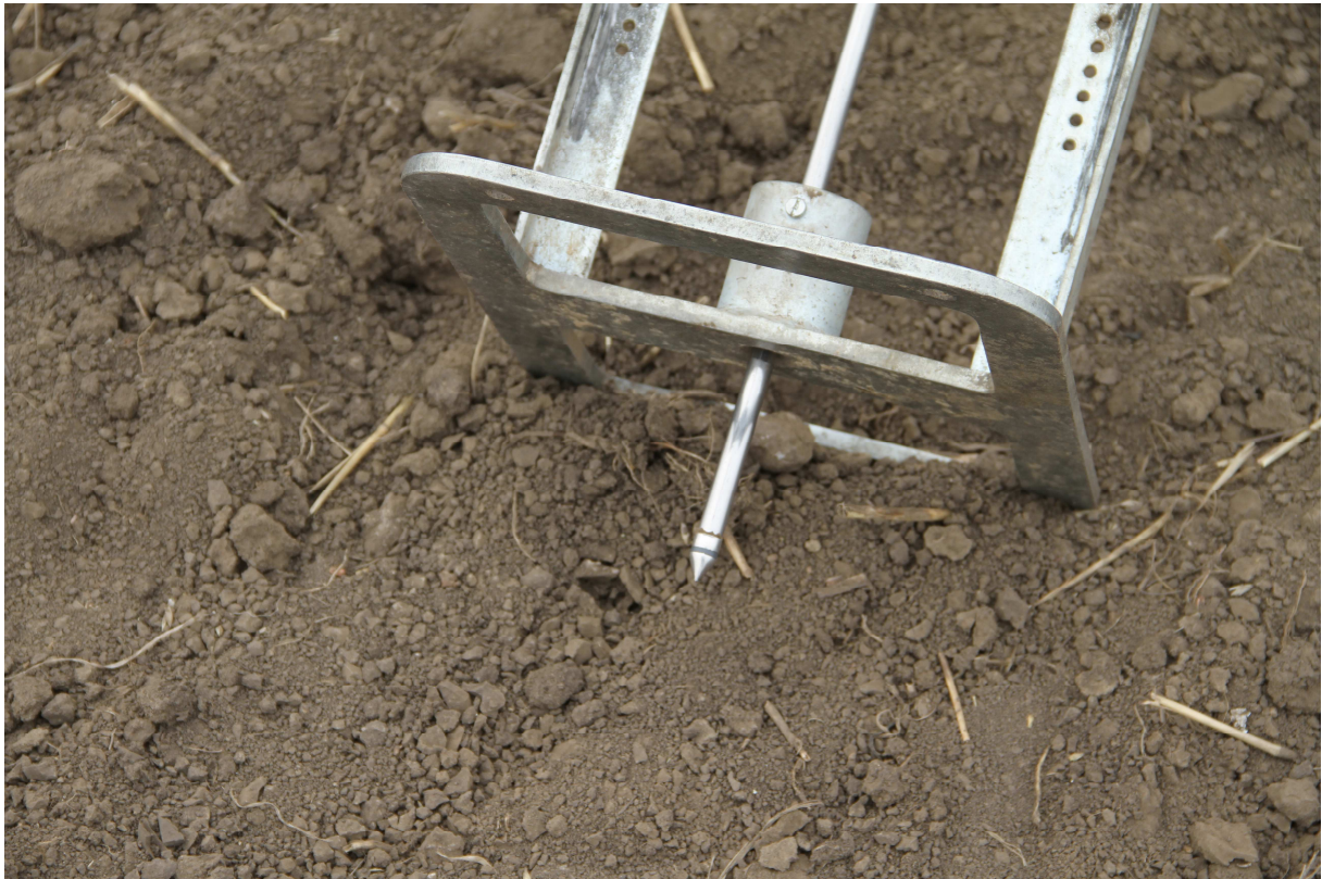
2. kép: A talajellenállásmérő szondakúpja
