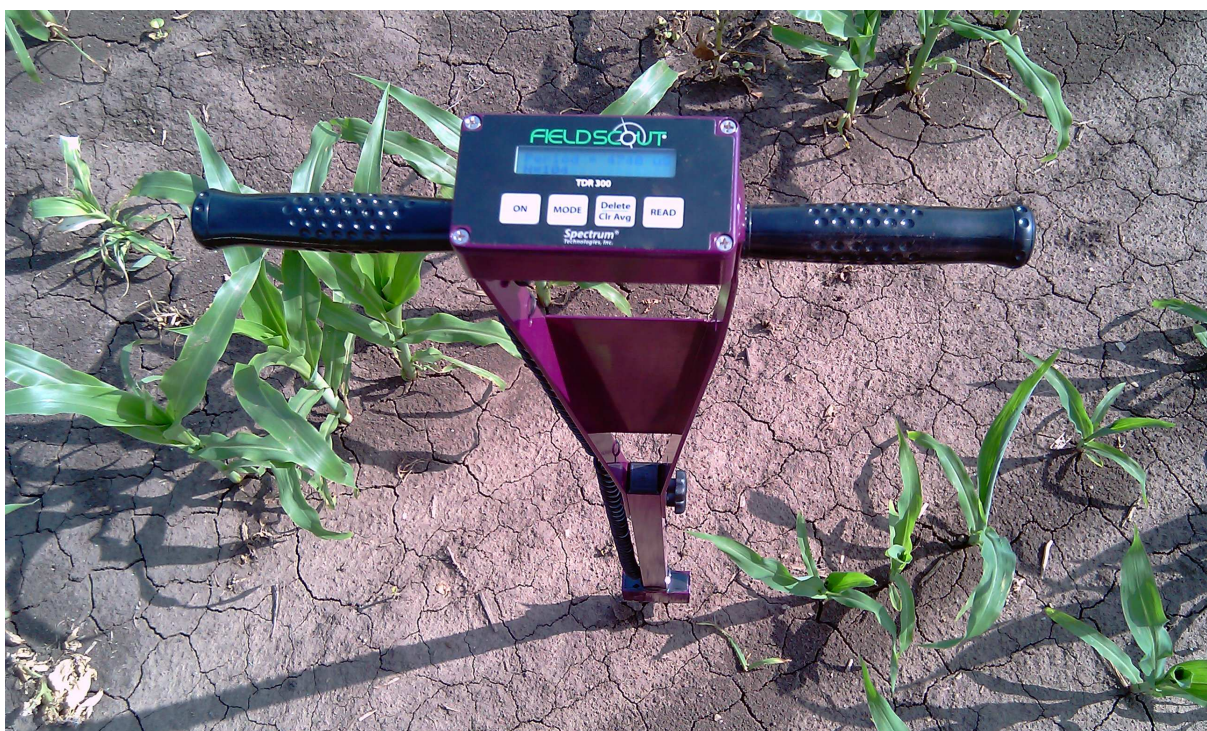
4. kép: TDR 300 talajnedvesség mérő szonda
