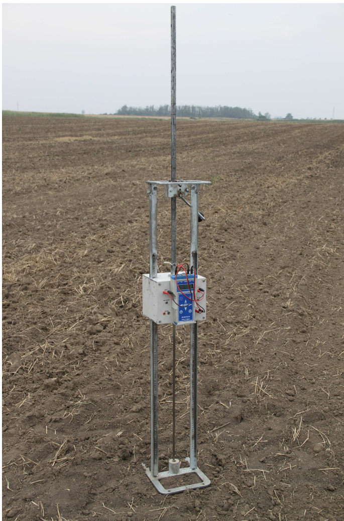
10. kép: Penetronik típusú talajellenállás és talajnedvesség mérő berendezés
