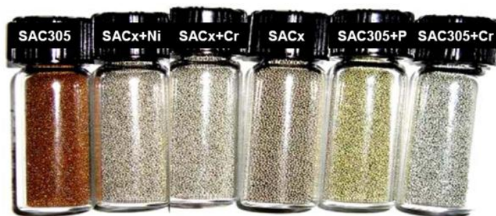
14. ábra Különböző mikroötvözőket tartalmazó forrasztók színe öregítés után [6]
